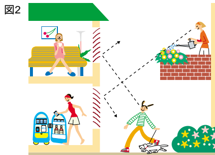
上からの視線をカットするにはスラットの凹面を室内側に、下からの視線を防ぐには凸面を室内側に向ける。
